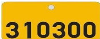
A placa de identificação deve ser em chapa de aço galvanizado ou similar, dimensões de 5cm x 14cm e 1 mm de espessura e os dígitos da numeração com 4cm de altura.
